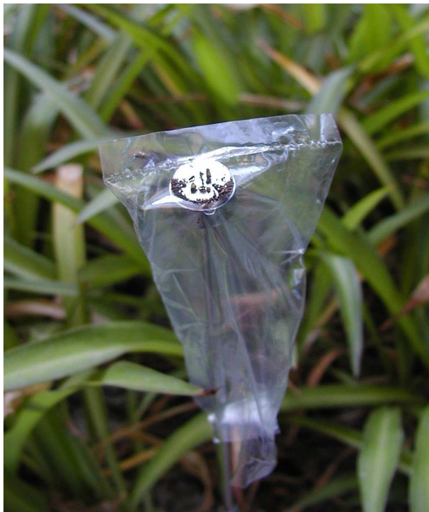
Un magnete avvolto in una bustina di plastica: così si possono captare dal fondo di pozzi e cisterne le sferule cosmiche di natura metallica. La cernita va fatta successivamente per mezzo di un normale microscopio.
