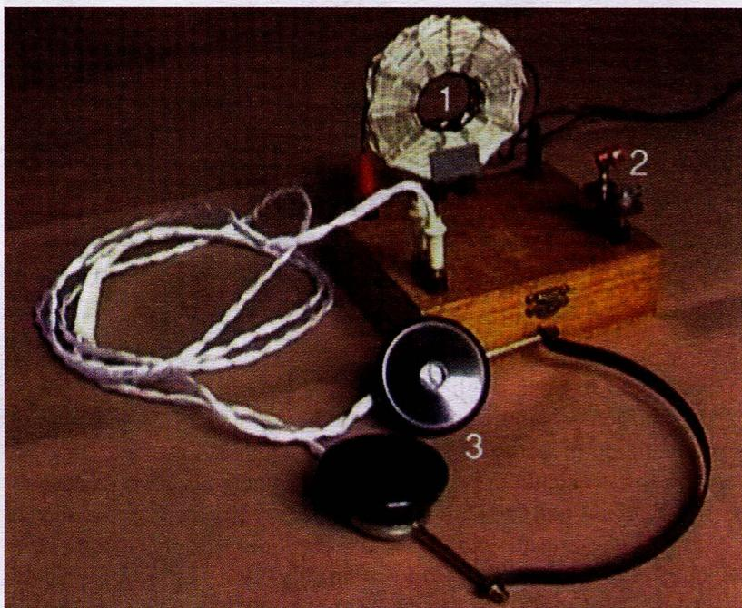
La nostra "replica" della radio a galena del confinato; 1. Bobina di induttanza a nido d'ape; 2. Detector a 'baffo di gatto' con cristallo di galena argentifera; 3. Cuffia con auricolari a alta impedenza (2000 Ohm).
